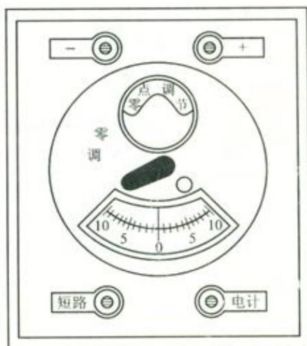
图 3-3 AC-5 型直流指针式检流计
