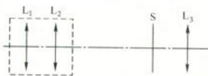
图 22-4 内调焦式望远镜光学结构示意图
